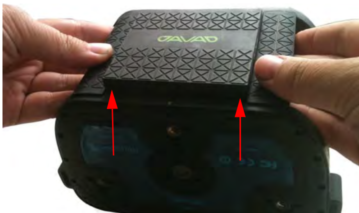
Рисунок 8. Выемка аккумуляторной батареи
