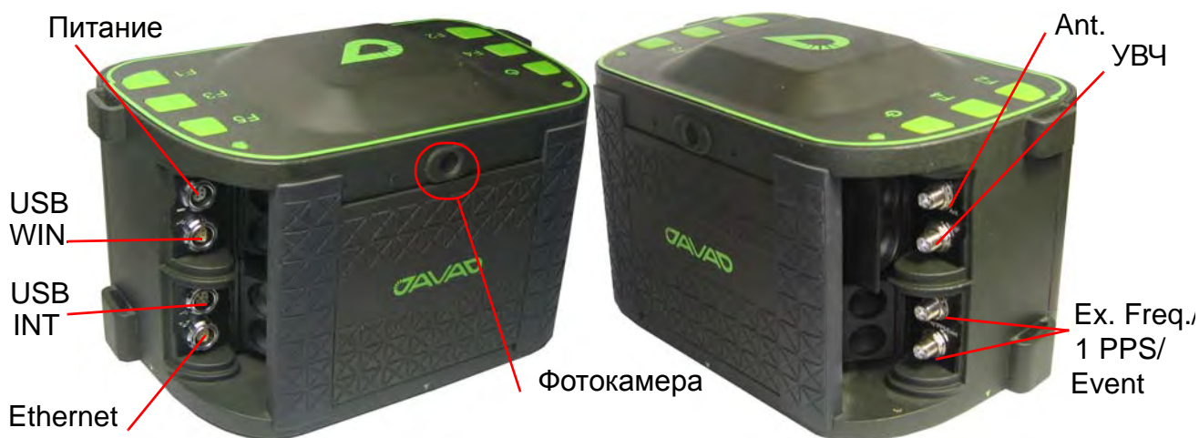
Рисунок 6. Порты приемника ТРИУМФ-ВС
