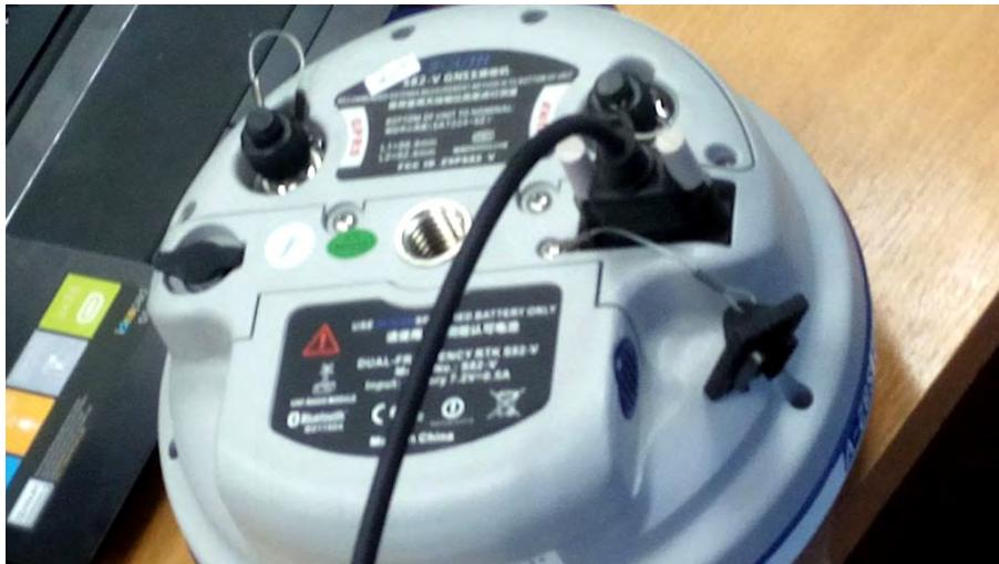
другим концом (на котором COM и USB) подключаем к компьютеру
