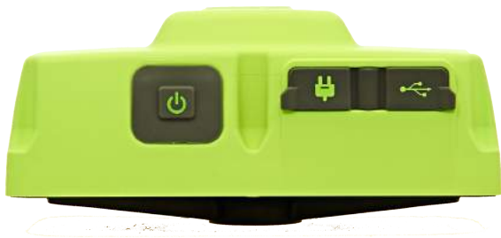
Рисунок 4. Кнопка вкл/выкл, разъемы питания и USB
