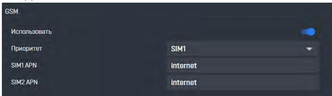
**Использовать** — активируйте переключатель, чтобы включить GSM-модем приемника.
