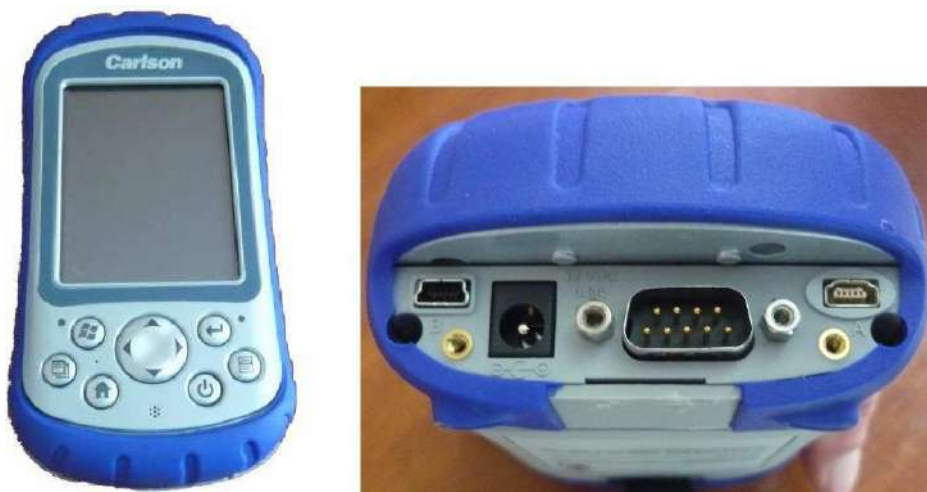
Рисунок 4.1. Внешний вид контроллера Carlson MINI
