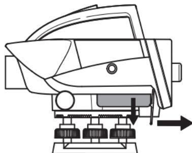
Возьмитесь одной рукой за открытый батарейный отсек, а другой рукой надавите на рычажок в направлении дисплея. Аккумулятор выйдет из отсека.
