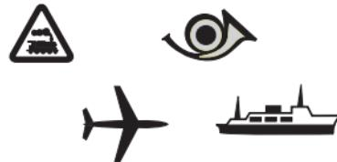
При перевозке нивелира электронного по железной дороге, воздуху или воде всегда используйте всю оригинальную упаковку Leica Geosystems, транспортировочный контейнер и картонную коробку или их эквиваленты с целью защиты его от ударов и вибрации.
