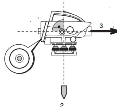
Компенсатор корректирует наклон оси вращения нивелира, вследствие чего его визирная ось становится горизонтальной.
