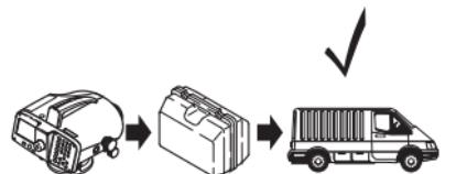
Не перевозите незакрепленный инструмент в транспорте. Удары и вибрация могут привести к повреждению инструмента. Всегда перевозите инструмент, упакованным в кейс.
