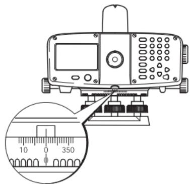
Ваш нивелир оборудован горизонтальным кругом. Он размечен в 360-градусной системой с шагом в  $1^\circ$ . Градовые деления нанесены под 360-градусной разметкой с шагом 50 град. Преобразование градусов в грады выполняется самим пользователем.
