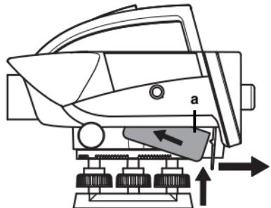
Вставляйте аккумулятор в направлении объектива (точка контакта а). Потяните рычажок в сторону дисплея и нажмите на аккумулятор в верхнем направлении до щелчка.
