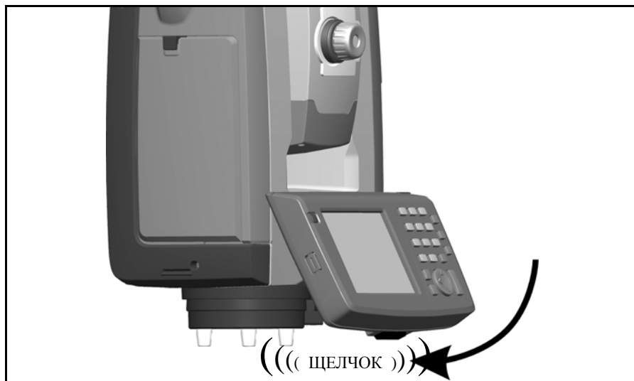
Рис. 4.36. Установка контроллера Trimble CU
