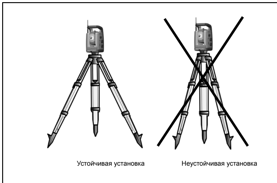
Рис. 6.48. Установка штатива
