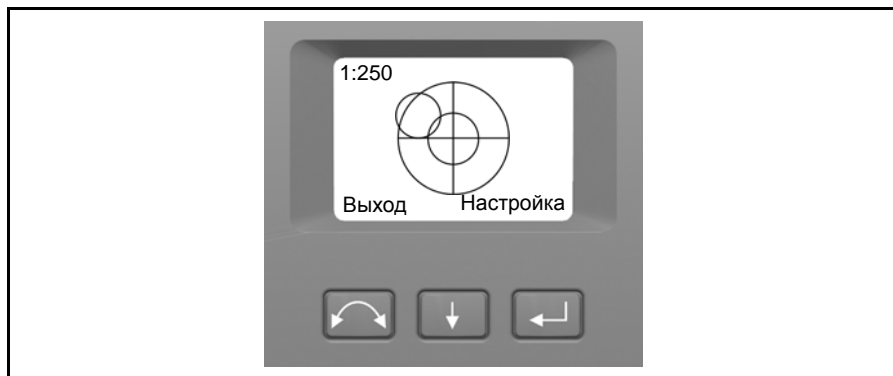
Рис. 3.18. Окно электронного горизонтирования на дисплее круга 2
