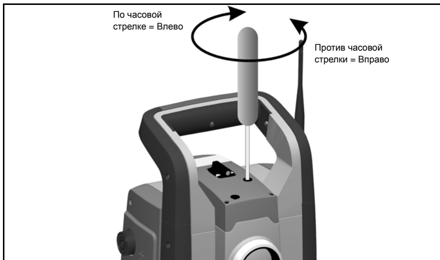
Рис. 4.31. Юстировка горизонтального положения
