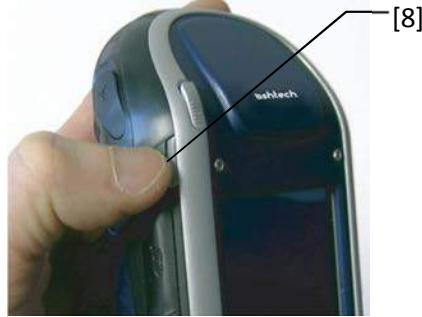
Чтобы возобновить работу приёмника, удерживайте нажатой эту же кнопку до возобновления работы экрана. Это сразу восстановит состояние, в котором был приёмник перед переходом в режим ожидания.
