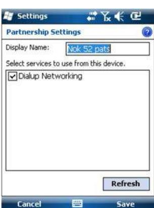
На приёмнике появится имя сотового телефона в списке «Отсоединенных» устройств (это означает, что образована пара между приёмником и телефоном, телефон доступен для соединения, но еще не подключен).
