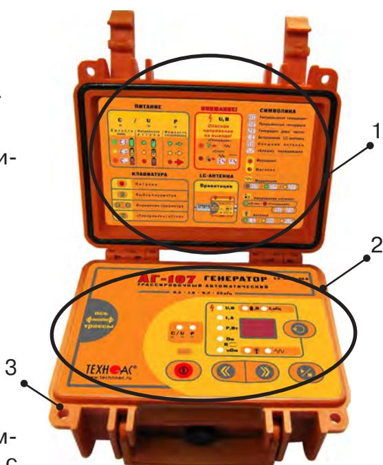
блении. Возможно **подключение внешней передающей антенны**, создающей особо интенсивное излучение и обеспечивающей непосредственный доступ к «заглубленным» коммуникациям. Подключаемые передающие **индукционные клещи** позволяют бесконтактным способом особо эффективно возбуждать трассировочный ток конкретно в одной «выделенной» из нескольких близлежащих коммуникаций (в том числе, находящейся под напряжением).
