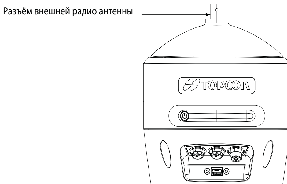
Рис. 4: Антенный купол приёмника HiPer HR и разъём внешней антенны
