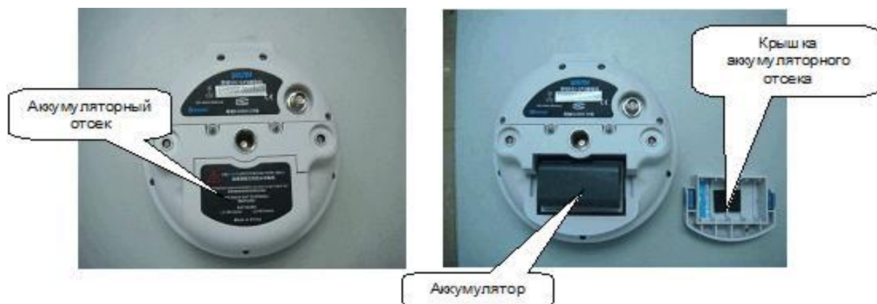
Рисунок 2.3 – Установка аккумулятора в S82V
