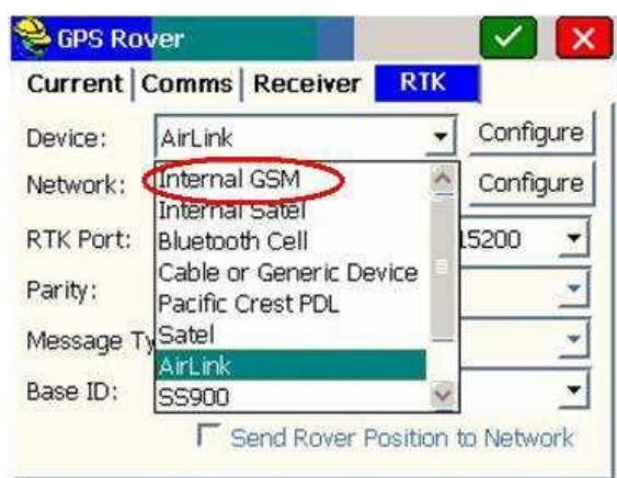
Рисунок 4.19. Окно настройки роверного приемника « GPS Rover »
