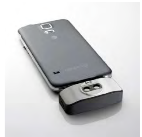
Рисунок 14.3 2015 г.: FLIR One, вспомогательное устройство для мобильных телефонов с операционной системой iPhone и Android. Вес: 90 г. .
