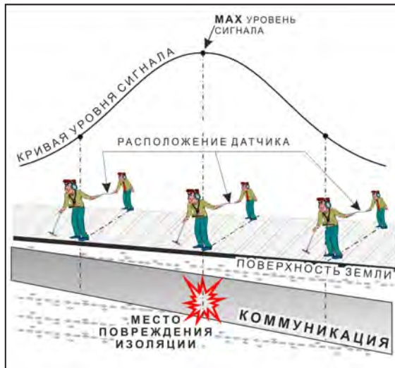
применение датчика-определителя дефектов коммуникации (ДОДК) методом max
