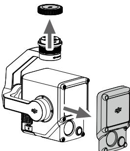
2. На дроне нажмите кнопку, используемую для отсоединения стабилизатора и камеры. Поверните крышку стабилизатора на дроне, чтобы снять ее.
