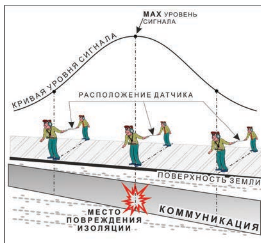
Применение датчика-определителя дефектов коммуникации (DODK) методом max
