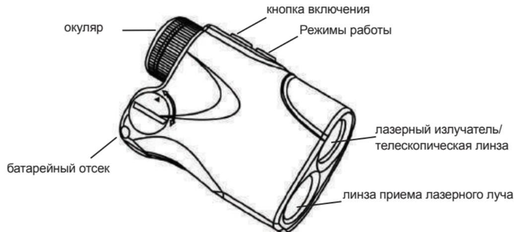
Рис.1. Устройство прибора
