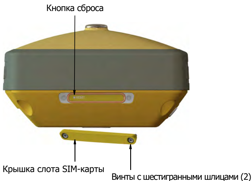
Рисунок 2-5: Удаление крышки слота SIM-карты
