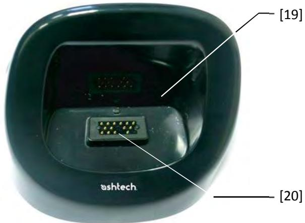
При виде сверху, виден отсек [19] док-станции в который нужно вставлять приёмник.
