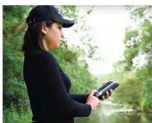
Связь со спутниками с Вашим приёмником требует, чтобы его использовали на открытом воздухе и держали надлежащим образом. Приёмник получает наилучший обзор неба, когда Вы держите его под углом от 30 до 45 градусов (в идеале – 38°) к горизонту и на расстоянии от тела.
