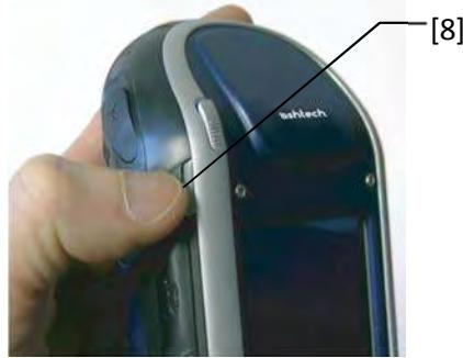
Чтобы возобновить работу приёмника, удерживайте нажатой эту же кнопку до возобновления работы экрана. Это сразу восстановит состояние, в котором был приёмник перед переходом в режим ожидания.
