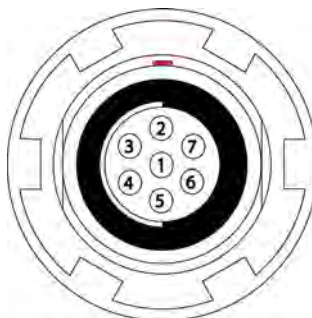
Рисунок 9-2: Разъем последовательного порта RS-232
