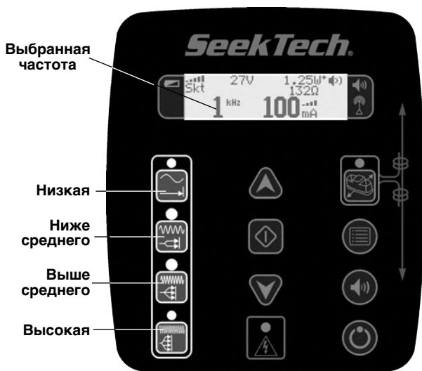
Рис. 19 – кнопки выбора частоты – приемник/локатор сторонних производителей
