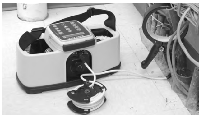
Рис. 12 – индукционный зажим подключен к проводнику
