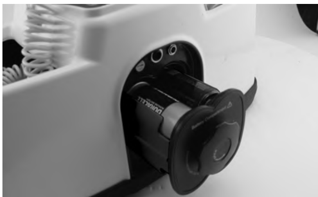
Рис. 6 – извлечение аккумуляторного отсека
