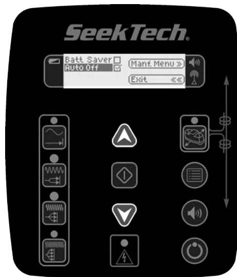
Рис. 21 – выбор параметров электрического потока (кнопки вверх и вниз)
