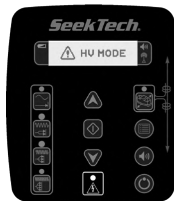
Рис. 9 – индикатор высокого напряжения.
