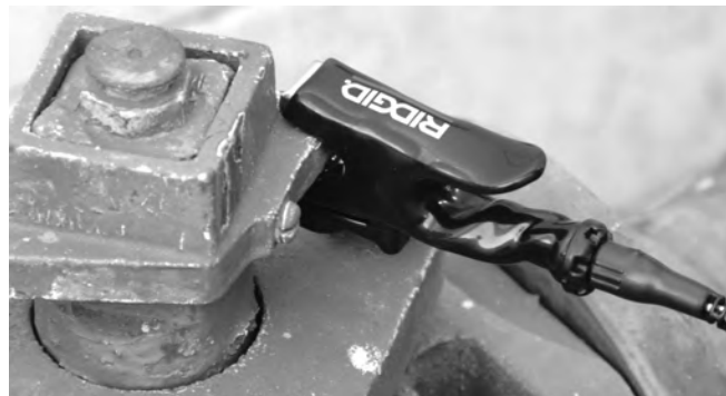
Рис. 8 – подсоединение провода кабеля к целевому проводнику
