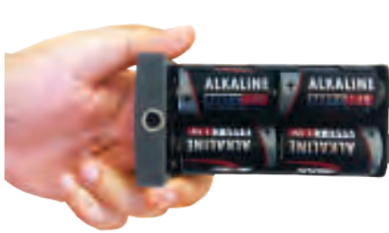
б) Вставить батареи в отсек, соблюдая полярность
