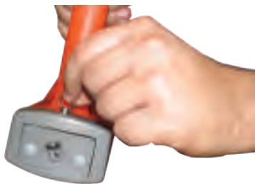
а) Выдвинуть фиксатор, освободить батарейный отсек
