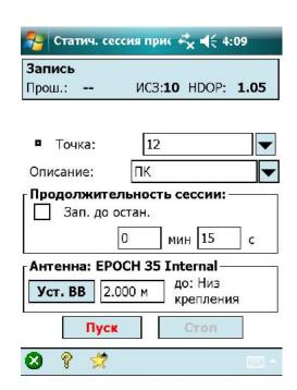
Чтобы закончить съёмку Stop&Go жмём «Х» на зелёном кружочке в левом нижнем углу экрана, затем «Завершить запись». Забиваем на тупость появляющегося при этом окна и жмём «Подключить >» (а тупость в том, что приёмник давно уже подключен!).
