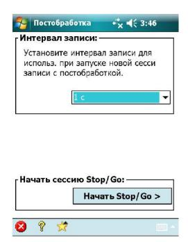
Здесь жмём «ОК». Далее ставим «галку» рядом с надписью «Зап. до остан.» , вводим номер точки описание, высоту антенны и нажимаем «Пуск».
