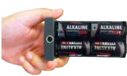
б) Вставить батареи в отсек, соблюдая полярность
